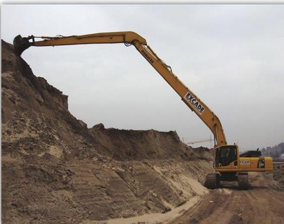
**ILUSTRACIÓN 9**RETROEXCAVADORA EN TALUD
